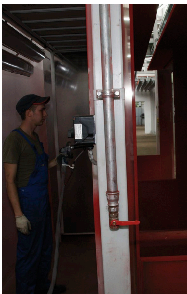
Kabina do ciekłego malowania.
