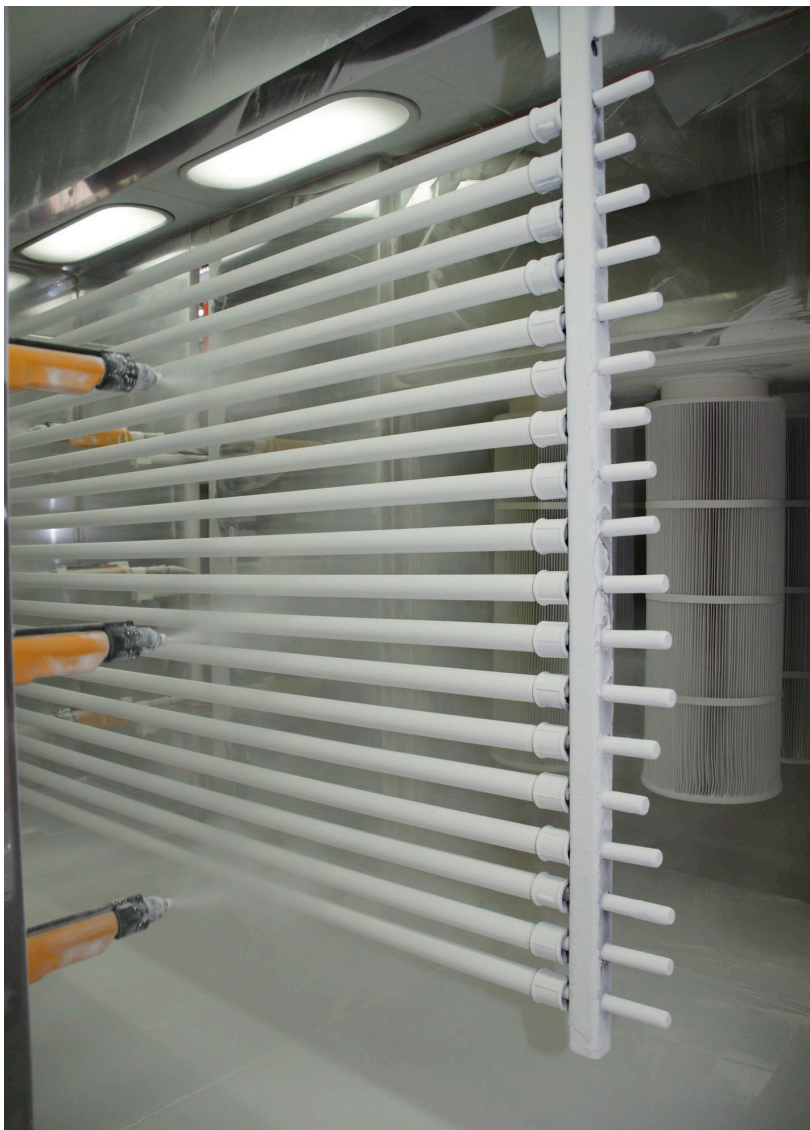
Kabina proszkowa obsługiwana jest przez 6 automatycznych pistoletów i 1 ręczny.
