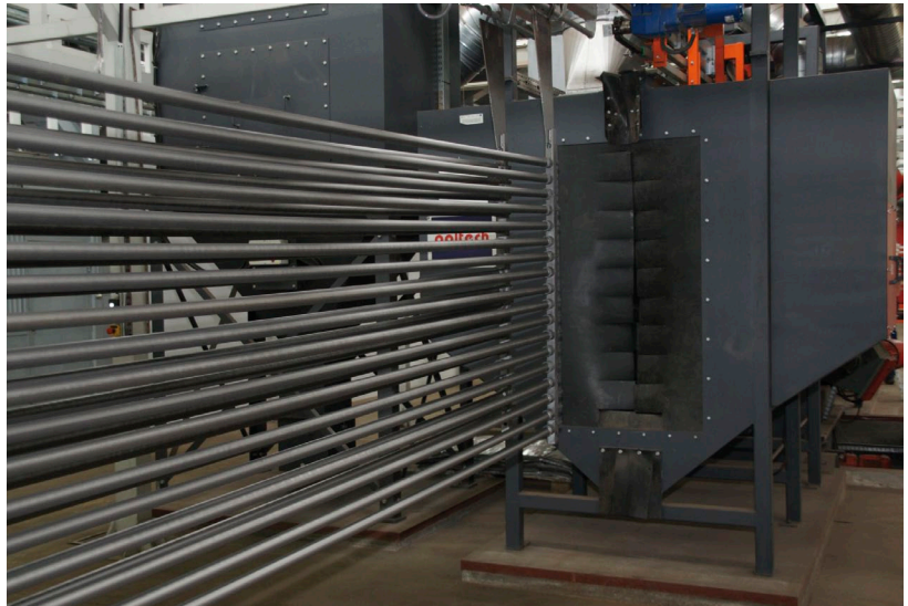
Detale są przygotowywane metodą strumieniowo-ścierną.
