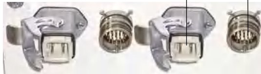
Oś pozioma XT09 - podłączenia elektryczne do manipulatora ZA
