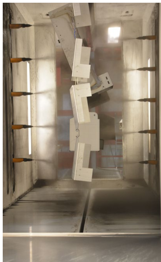
↑ Kabina proszkowa z podłogą wyposażoną w system czyszczenia.
