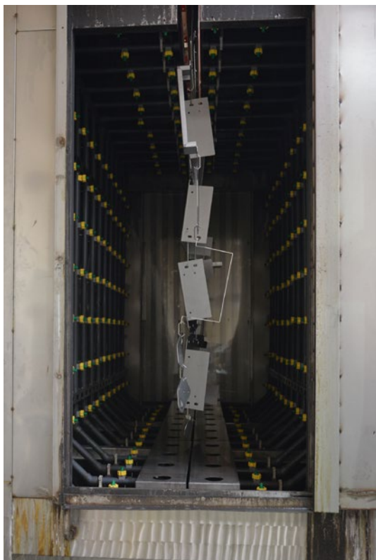
↑ Elementy tuż po wejściu do tunelu przygotowania powierzchni. Pierwszy etap obejmuje odtłuszczenie.
