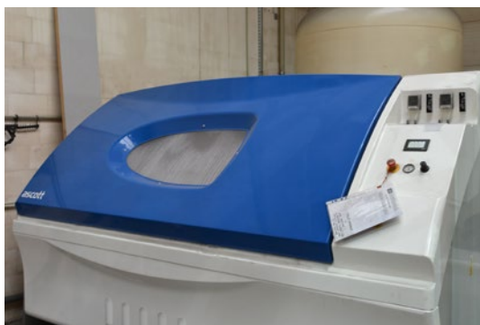
↑ Na wyposażeniu lakierni jest również komora solna, w której dokonuje się badań odporności korozyjnej.
