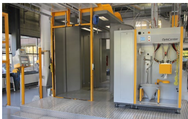
↑ Wejście typowej, uniwersalnej kabiny z szybką zmianą koloru. Widoczna brama rozpoznająca wysokość i szerokość.
