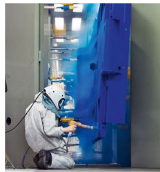
↑ Konieczność ręcznego domalowywania zagłębień detalu, których nie jest w stanie przeskanować typowy układ rozpoznania.
