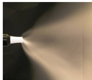
Zbyt mało powietrza całkowitego
