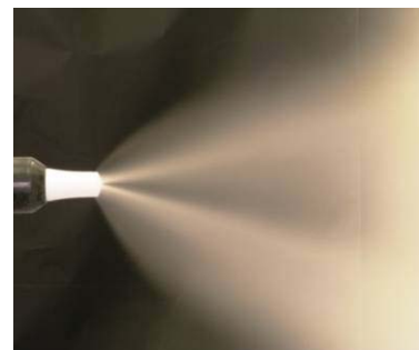
Za dużo powietrza odmuchu elektrody
