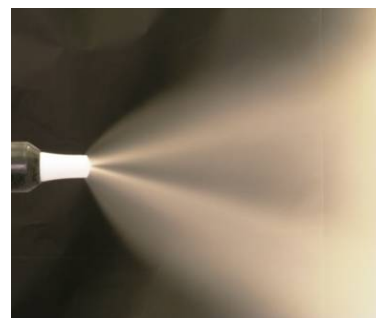
Za dużo powietrza odmuchu elektrody
