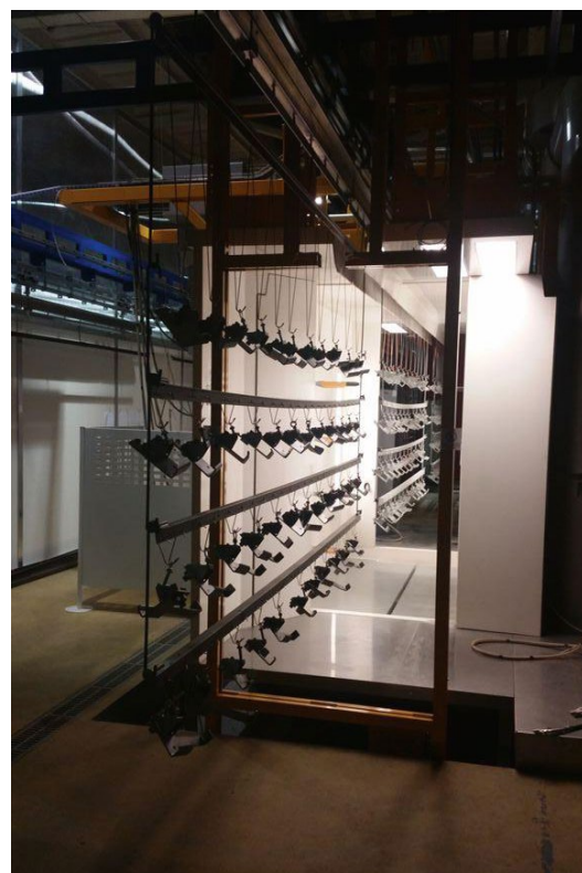
↓ Elementy przechodzą przez kabinę do szybkiej zmiany koloru firmy Gema Magic Compact.
