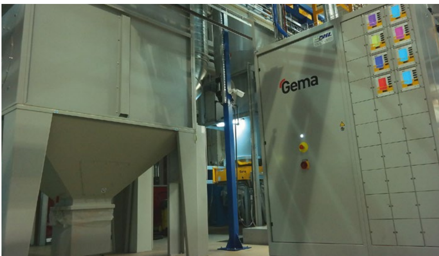
↑ Szafa sterująca automatycznymi aplikacjami, po lewej stronie cyklon.
