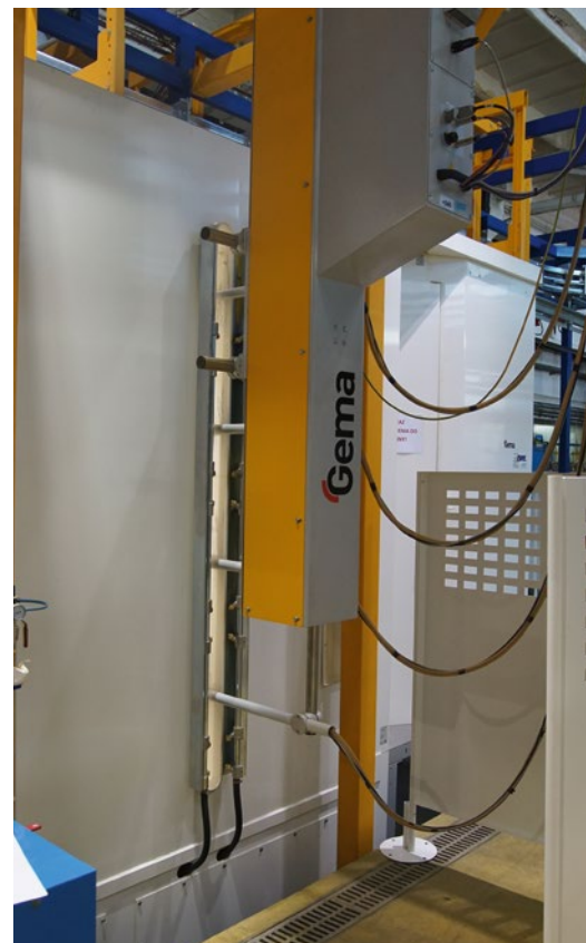
↓ Na każdym manipulatorze zamontowano po cztery pistolety.
