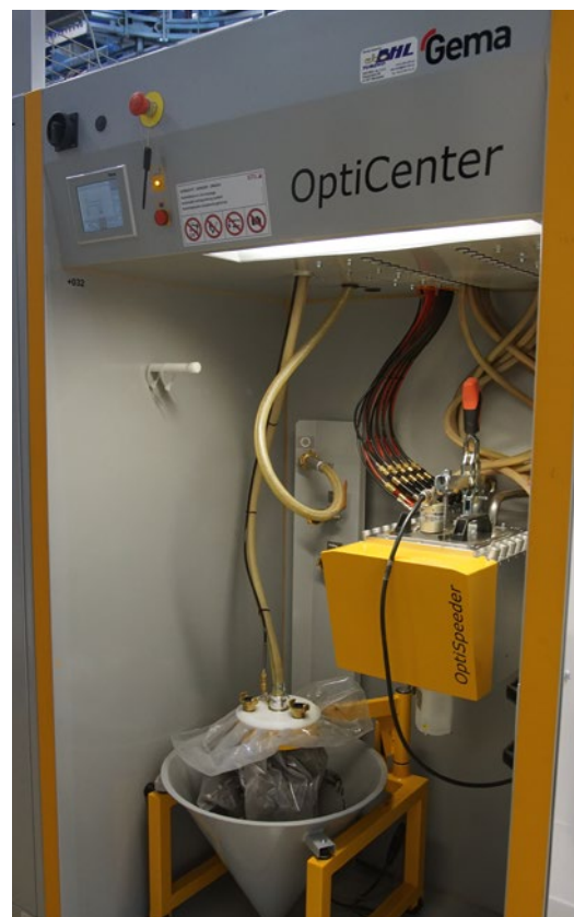
↑ Centrum proszkowe OptiCenter, czyli tzw. kuchnia farb z sitem ultradźwiękowym.
