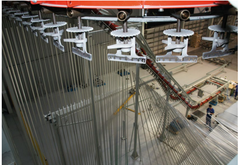
W lakierni wertykalnej profile są stopniowo unoszone ku górze do pozycji pionowej.
