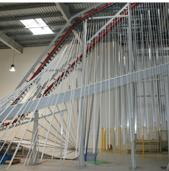
Nowa malarnia umożliwia lakierowanie profili aluminiowych o długości do 7500 mm.
