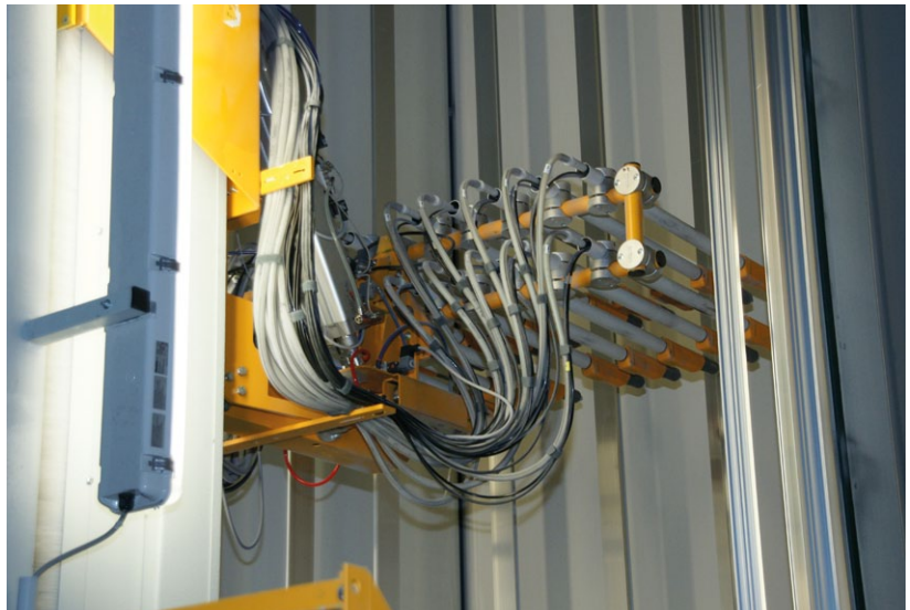
Dwadzieścia pistoletów pracuje w kierunku góra – dół.
