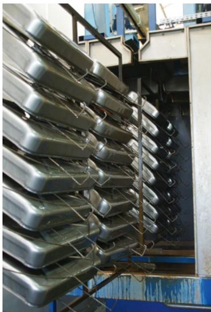
Antykorozyjna kąpiel zabezpiecza metal i gwarantuje wysoką wytrzymałość farby.
