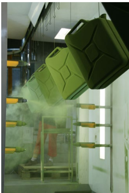
Kabina wyposażona jest w osiem automatycznych i dwa ręczne pistolety.
