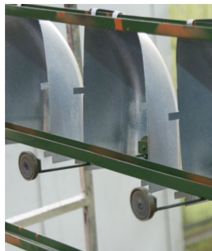
Zawieszki magnetyczne pozwalają na efektywne malowanie detali tylko z jednej strony.
