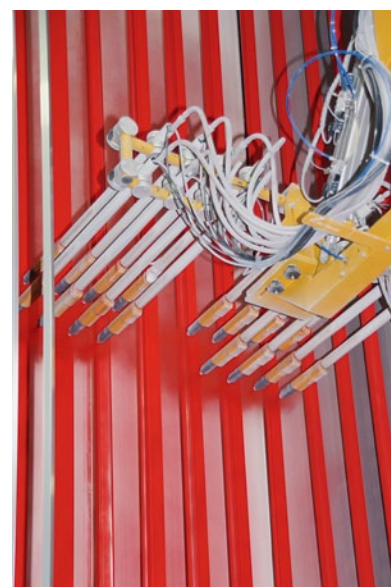
Pistolety pracują w kierunku góra-dół.
