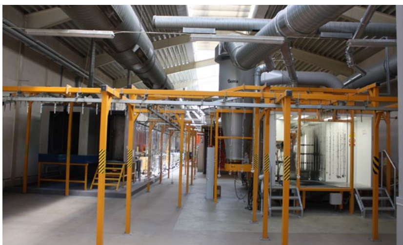
Hala lakierni Zakładu Produkcji Automatyki Sieciowej S.A. z siedzibą w Przygórze. Po lewej myjka, po prawej kabina lakiernicza.
