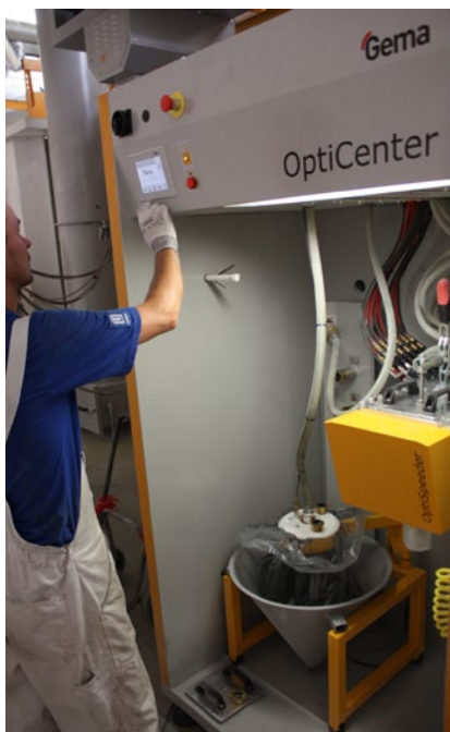
Jednostka dozowania proszku OptiCenter marki Gema daje możliwość szybkiej i pozbawionej wtrąceń zmiany koloru.
