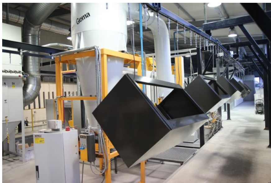
Malowanie proszkowe w firmie Kordas to ostatni i zwińczający etap produkcji – podsumowanie ich jakości i rzetelności.
