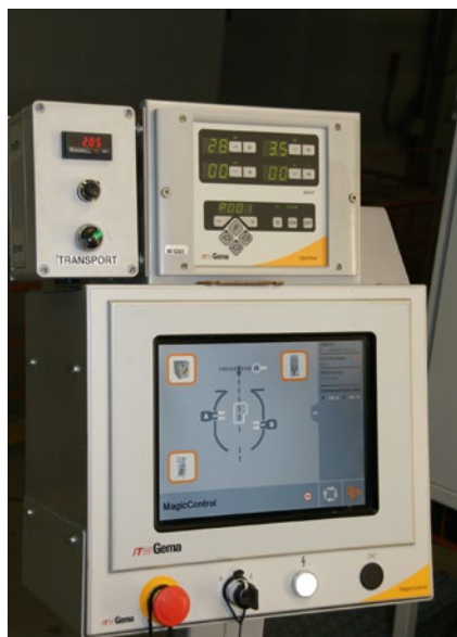
Jednostka sterująca pracą kabiny automatycznej.
