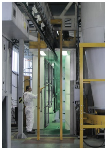
Automatyczna kabina MagicCompact EquiFlow do szybkiej zmiany kolorów.
