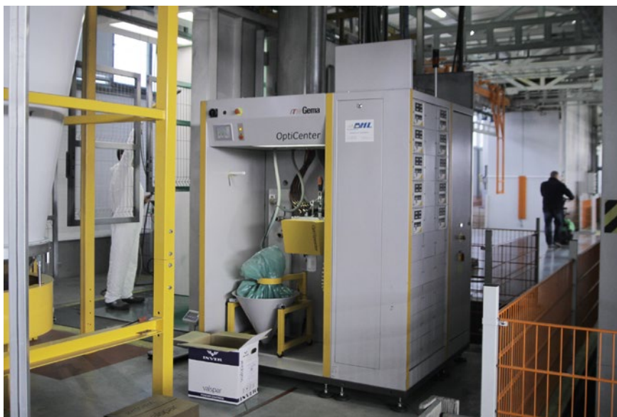
OptiCenter zintegrowana z szafą sterującą do zarządzania farbą proszkową.
