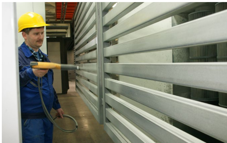
Ręcznie malowane są newralgiczne miejsca po cynkowaniu ogniowym...
