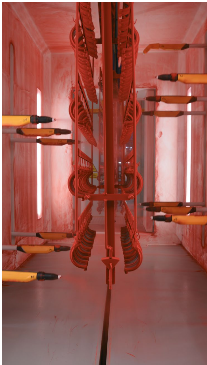
Jedna z kabin Gema MagicCompact EquiFlow do szybkiej zmiany koloru wyposażona w centrum proszkowe OptiCenter All-in-One.
